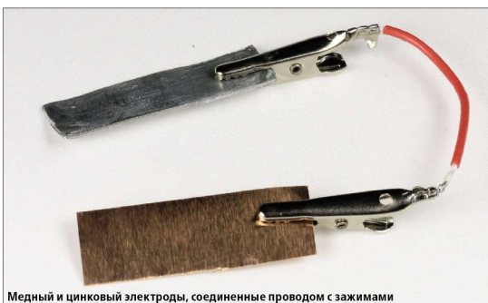
Медный и цинковый электроды, соединенные проводом с зажимами
